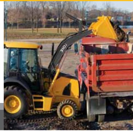
El diseño de cargadora con aguilón curvo mejora la visibilidad y provee excelente alcance para vaciar fácilmente el material a la parte central del camión. Para cargas más llenas, rápidamente.
