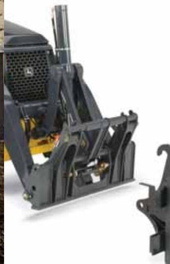
El acoplador de conexión rápida Worksite Pro™ le permite cambiar de accesorios rápida y fácilmente sin levantarse del asiento. Acepta una gran variedad de accesorios.
