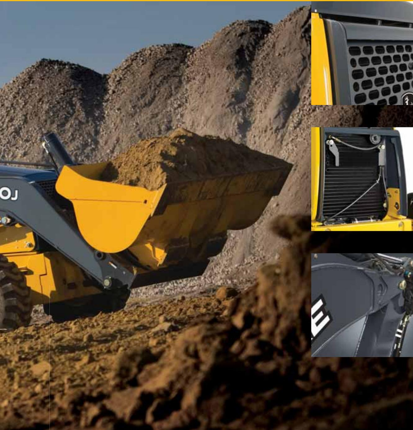
El capó del motor está construido en un material compuesto resiliente que resiste los choques y el daño. Las extensiones estándar de la parrilla añaden protección al extremo delantero.
