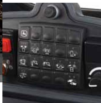
Los botones con iluminación de fondo ofrecen el control conveniente de las funciones de desenganche de altura del aguilón, retorno para excavar y retorno a la posición de acarreo directamente del asiento.
