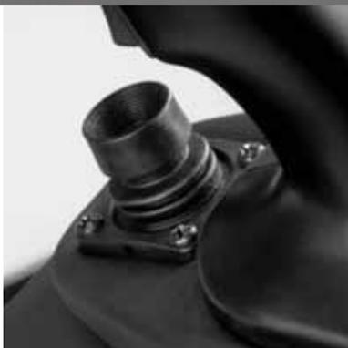
¿Necesita cambiar la máquina de posición rápidamente o desatascarla? La minipalanca le permite manejar la cargadora y la retroexcavadora simultáneamente sin quitar las manos de las palancas de control o girar el asiento.
