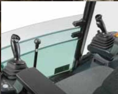
Las palancas que evitan la fatiga ofrecen control intuitivo suave de los accesorios auxiliares de cargadora, el brazo extensible, los accesorios auxiliares de retroexcavadora, el martillo, la tracción delantera mecánica y la bocina.
